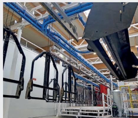
Brumificación a la izquierda y piezas entrando en el Horno de Secado de Humedad.
