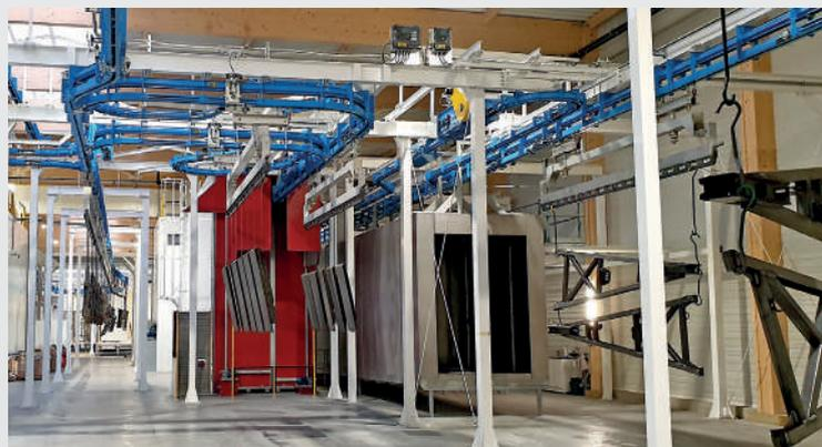
Túnel a la derecha y horno de secado de humedad a la izquierda.
