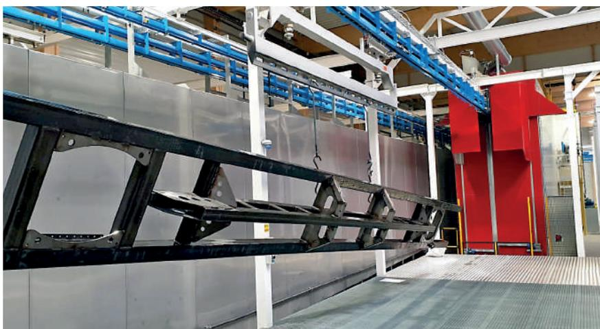
Tunnel à gauche et pièce entrant dans l'étuve.
